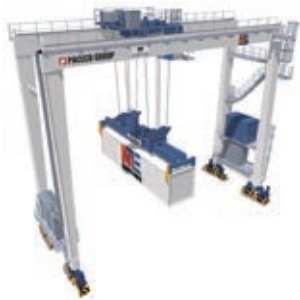
将来の水素社会の到来を見据え、電源装置を水素燃料電池(FC)に換装し、ゼロエミッションを達成することが可能なニアゼロエミッション型トランスターナー®
