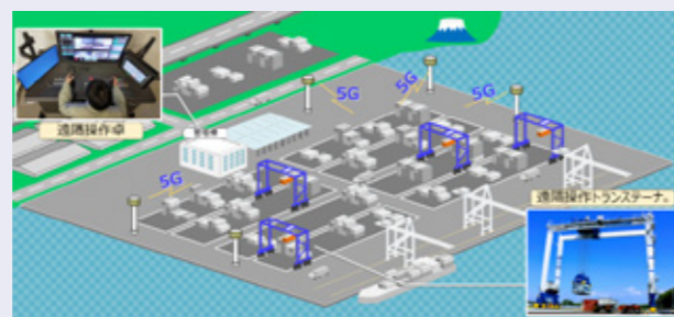
● コンテナターミナルにおけるローカル5G通信構成図
