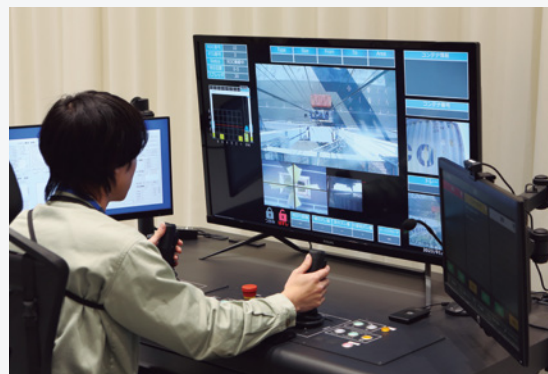
遠隔自動トランスレーナ用操作卓
