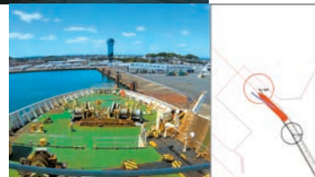
実証試験中のブリッジからの展望と自動操船システム画面
