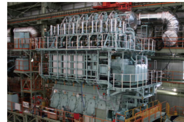
高圧EGR搭載の大型船用エンジン
