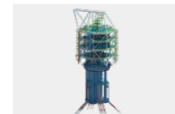
受注した浮体式生産設備の船体内部に組付けられる大型のインターナル・タレット (Internal Turret) (一点係留設備)
