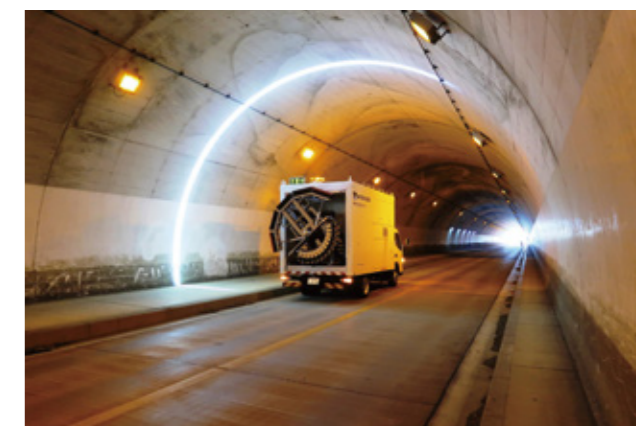
トンネル検査車両「トンネルキャッチャー3」
