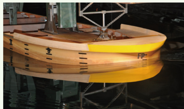
(株)三井造船昭島研究所において実施した模型による水槽試験
