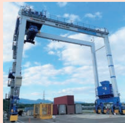
実証試験に成功したFC/パワーパック搭載のRTGC
