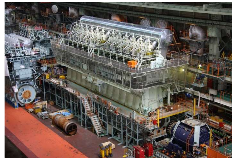
試験運転台に搭載された船用エンジン
