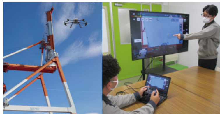
ドローンによるクレーン点検
