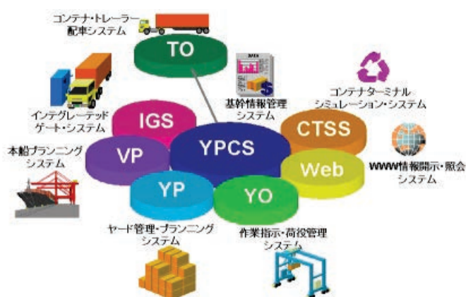
図5 総合コンテナターミナルマネジメントシステム CTMS の構成
