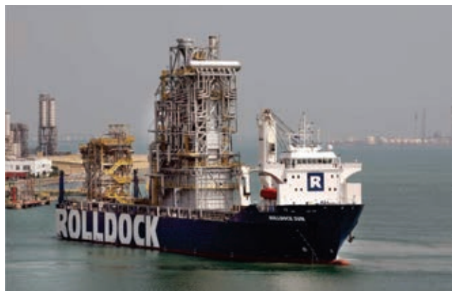
写真 8 エチレン分解炉モジュール・海上輸送の様子
