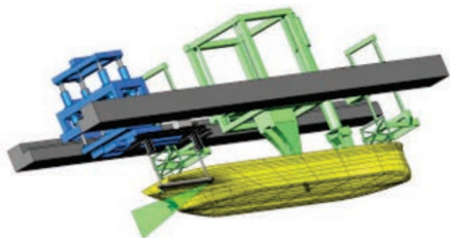
図2 PIV システム構成図 Experimental Set Up of PIV System
