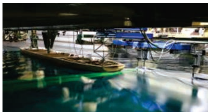
写真2 大水槽における PIV 計測状況 PIV Measurement at Large Towing Tank
