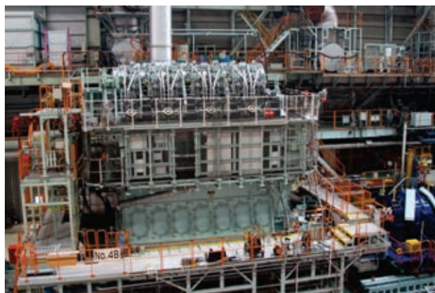
写真 2 メタノール焼き機関の世界初号機（7S50ME-B9.3-LGIM）
