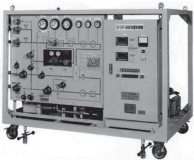
写真5 SF6ガス回収装置(液化回収・移動式)
