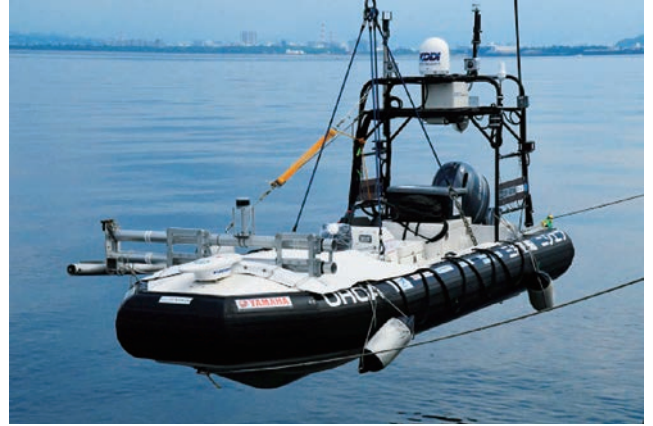
写真2 ASV (洋上中継器)
