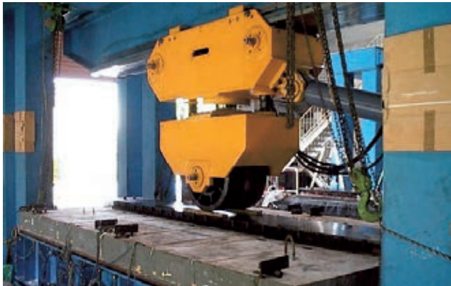
写真4 輪荷重走行試験(土木研究所)
