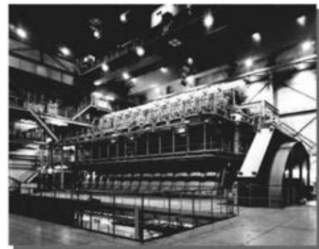
写真2 ガスインジェクション発電設備 (12K80MC-GI-S 40 680 kWm x 103.4 min -1 )
