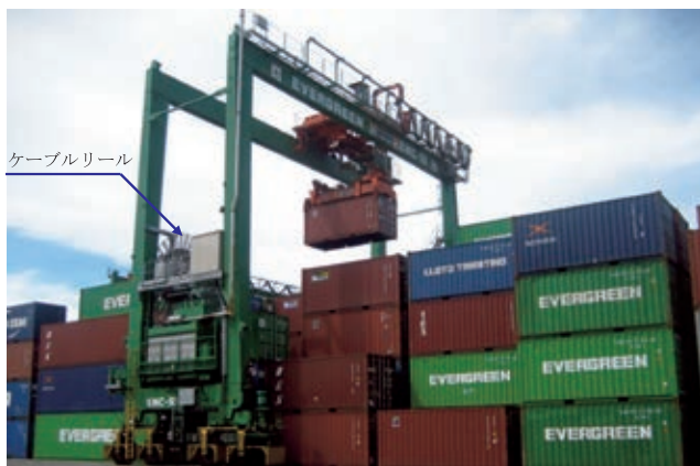
写真2 ケーブルリール方式
