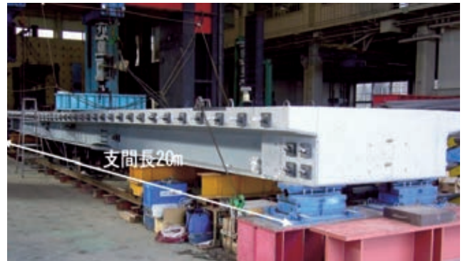
写真2 実物大2主桁の疲労試験
