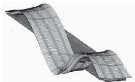
(a) 曲げ1次モード : 5.39 Hz : 解析値 5.2 Hz : 実験値
