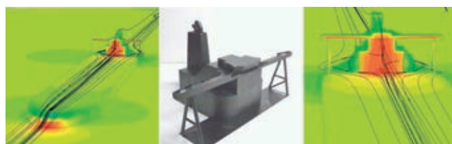
図 VLCCの風圧抵抗計算および風洞模型
