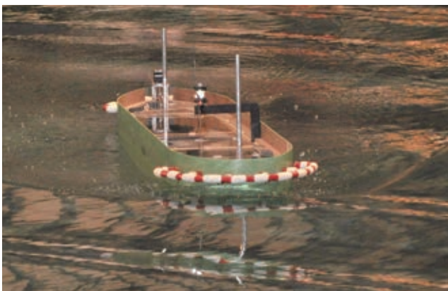
写真1 斜波中水槽実験 Model Ship Experiment in Oblique Sea
