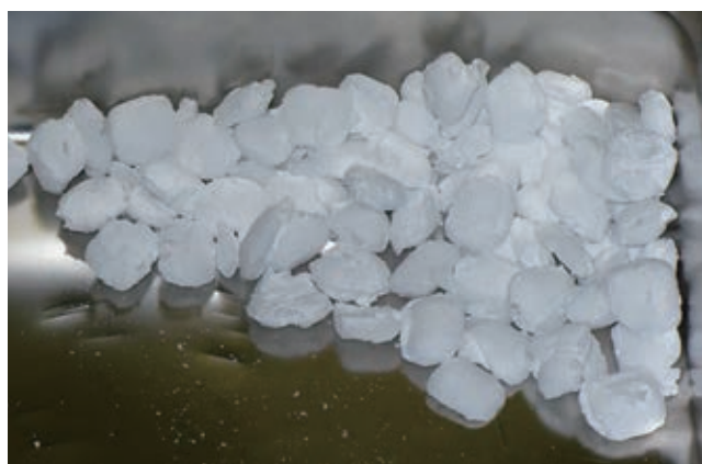
写真 2 冷却槽入口ペレット (ロール回転数 4 rpm, トルク 18 N・m) Sample of NGH Pellet at Inlet of Cooling Drum (Roll Revolution : 4rpm, Torque : 18N・m)
