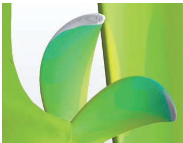
図6 CFDによるキャビテーション計算 Cavitation Calculation by CFD
