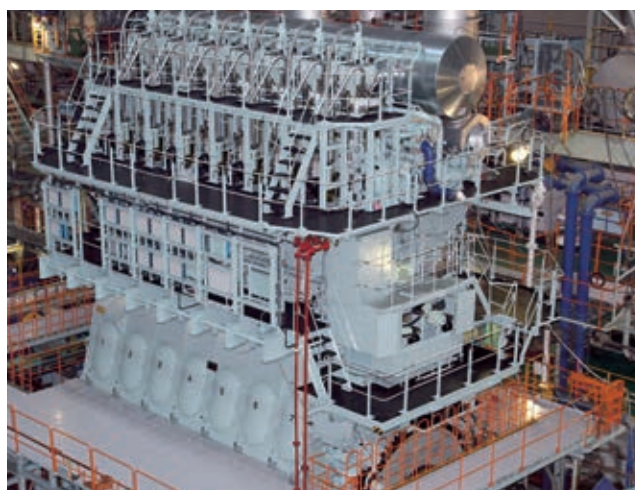
図8 電子制御エンジン Electronically Controlled Diesel Engine
