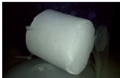
写真1 メタン、エタン、プロパン混合ガスハイドレートの円柱状ペレットサンプル Cylindrical Pellet Sample of CH 4 -C 2 H 6 -C 3 H 8 Mixed Gas Hydrate
