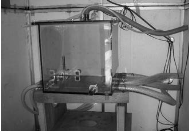
写真3 貨物倉模型(管路A) Hold Model(Pipe Line A)
