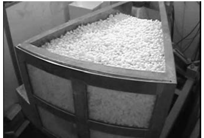
写真3 ペレットによる抽出試験の状況 Discharging Test of NGH Pellets
