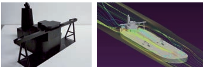
図 10 居住区模型と CFD での流れのシミュレーション Model of Accommodation and Flow Simulation by CFD
