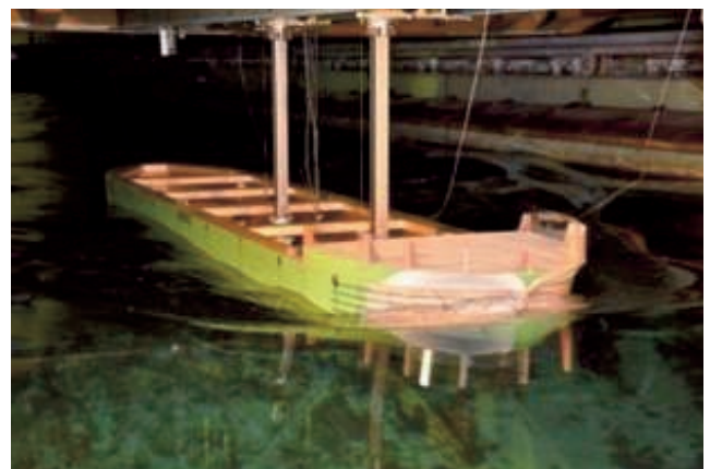
図 11 波浪中の抵抗試験 Resistance Test in Waves
