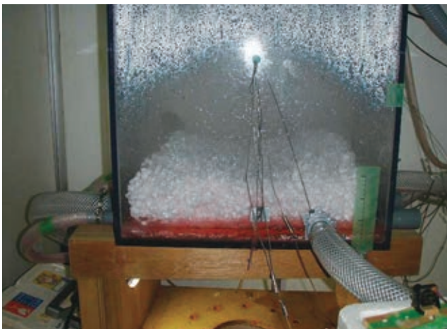
写真5 上部スプレー方式の試験状況 Hold Model during Test of Overhead Spray Method
