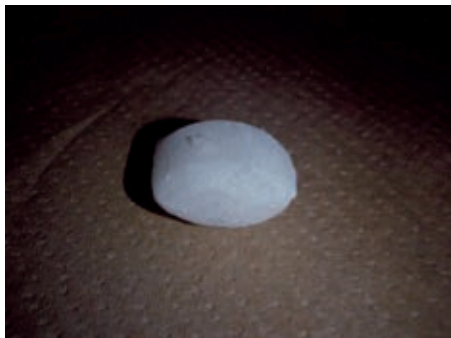
写真 3 連続試験装置で製造したペレットの外観 Pellet Produced in Bench Scale Unit
