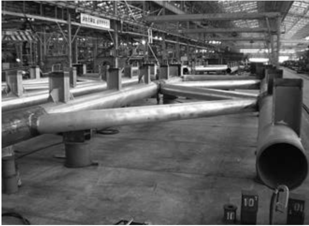
写真2 鋼管トラス製作状況1
