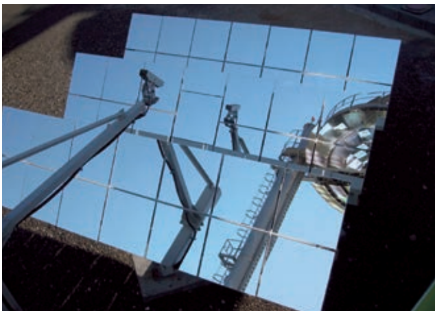
写真2 ヘリオスタット Heliostat
