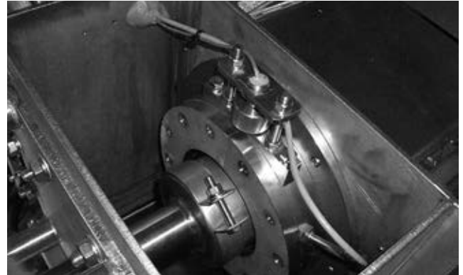
写真2 水分計センサの取付状況
