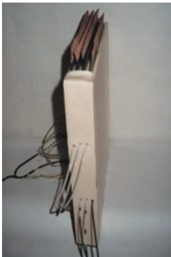
写真2 一体化した発泡ポリプロピレン製セルスタック Monoblock Cell Stack Made of Polypropylene Foam
