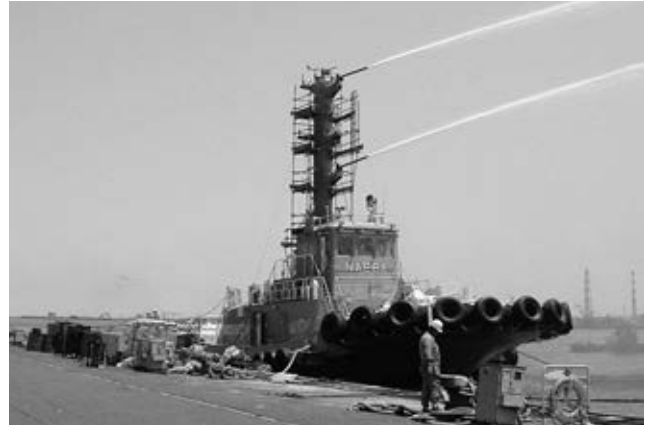
写真2 放水試験中の“なえば丸”
