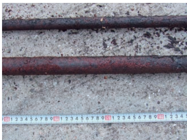
写真1 配管に発生した保温材下腐食(CUI)の例 Examples of Corrosion under Insulation(CUI) on the Piping
