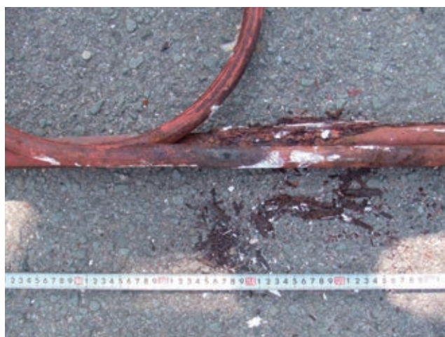
写真1 配管に発生した保温材下腐食(CUI)の例 Examples of Corrosion under Insulation(CUI) on the Piping
