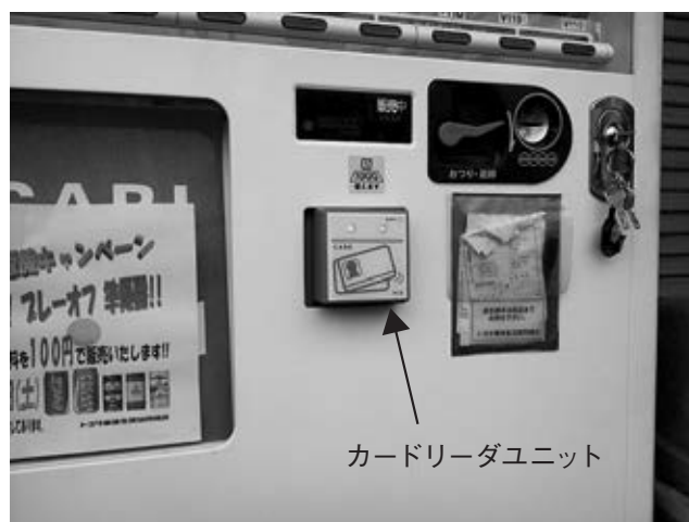
写真2 自動販売機へのカードリーダーユニットの装着状況
