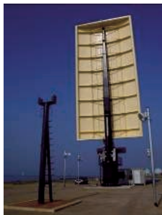
写真1 補助帆 Power Assist Sail のプロトタイプ Prototype of Power Assist Sail
