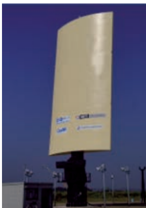
写真1 補助帆 Power Assist Sail のプロトタイプ Prototype of Power Assist Sail
