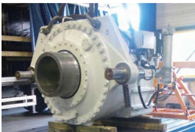
写真6 開発した2 MW ギヤボックス
