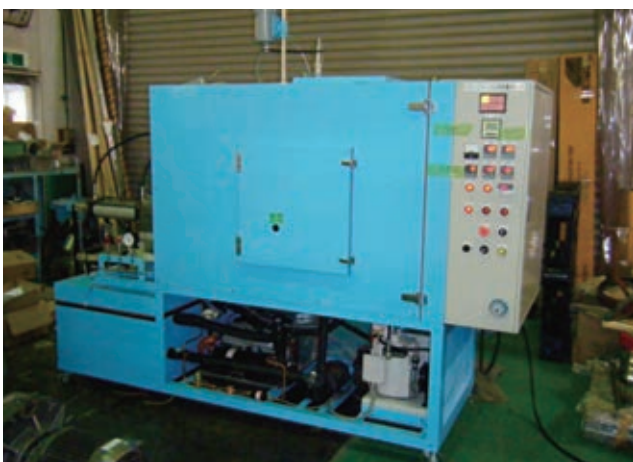
写真1 ハイドレート生成圧搾装置 Hydrate Formation and Compression Apparatus
