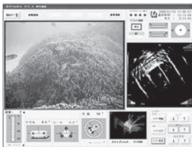
図2 小型水中テレビロボットRTV.Nシリーズの操作画面
