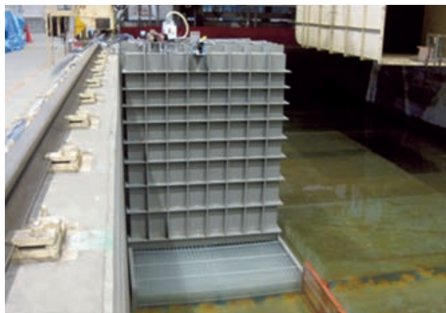
写真1 津波水槽のタンク部外観 Appearance of Pulling-up Water Tank
