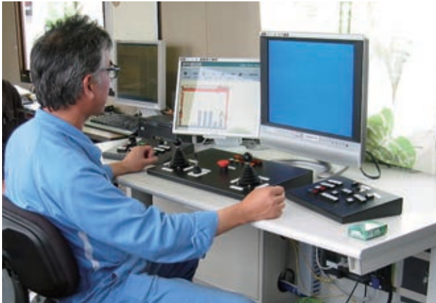
写真 14 トランステナーの遠隔運転
