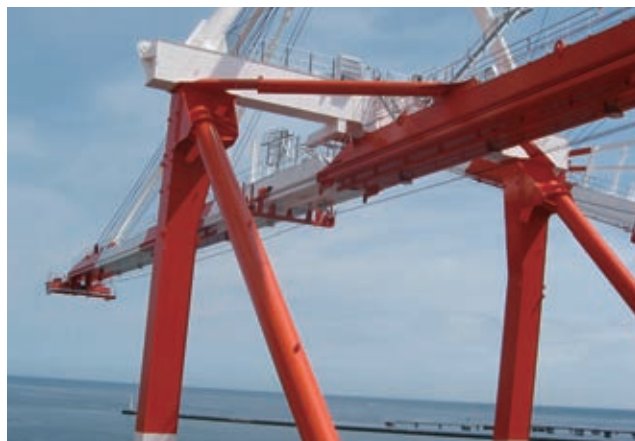
写真5 モノボックス式ブーム・ガーダ
