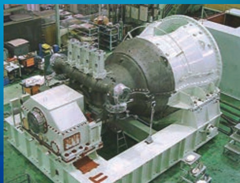
直結式一軸型: 30MW~150MW
