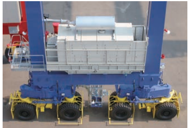
写真10 16輪型走行装置
