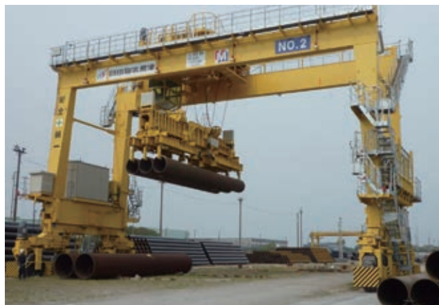
写真20 タイヤ式製品搬送クレーン
