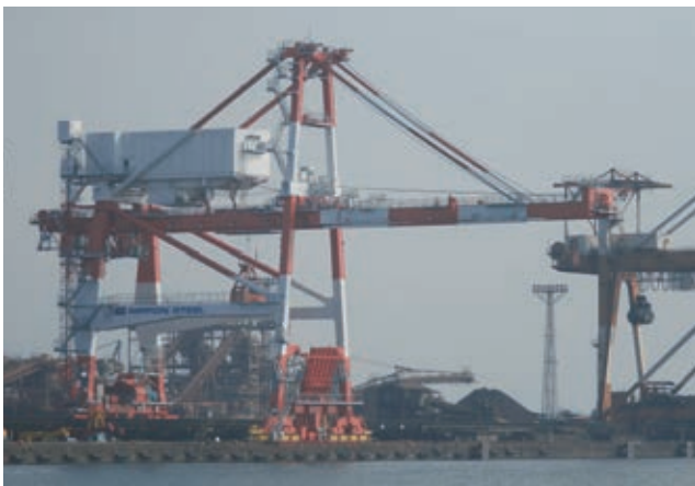
写真 17 グラブバケット式アンローダ
