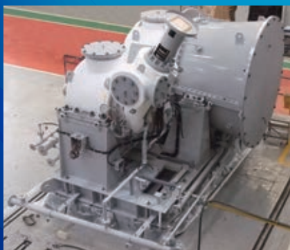
高速二軸型: 3MW~100MW
