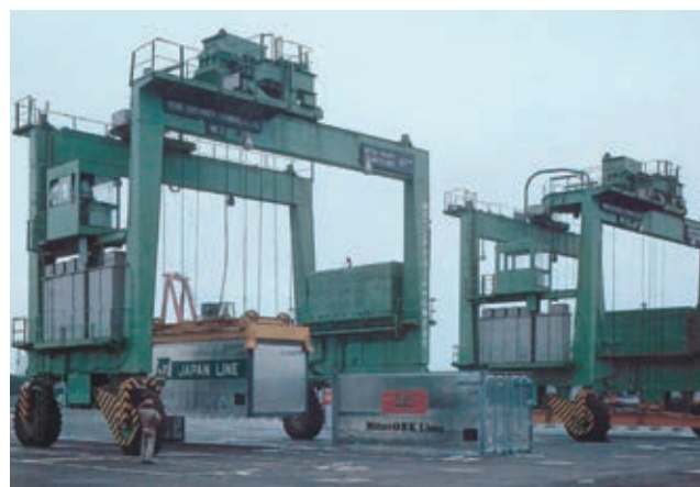
写真2 日本初の蔵置ヤード用タイヤ式門型クレーン(トランステーナ)
