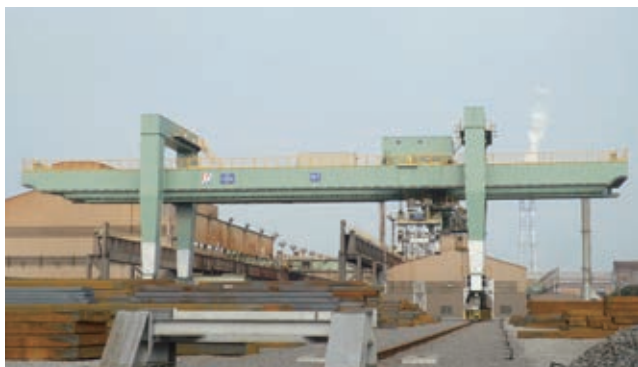
写真19 鋼片荷役用門型クレーン
