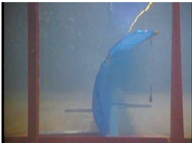
写真4 津波流れ中の幕状防波堤の展張状態 Stretched Sheet Structure in Tsunami Flow
