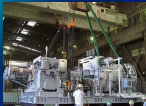
減速式一軸型: 25MW~50MW
