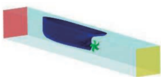
図 14 ダミー模型船を含む CFD 解析領域 CFD Calculation Domain with Dummy Ship Model
