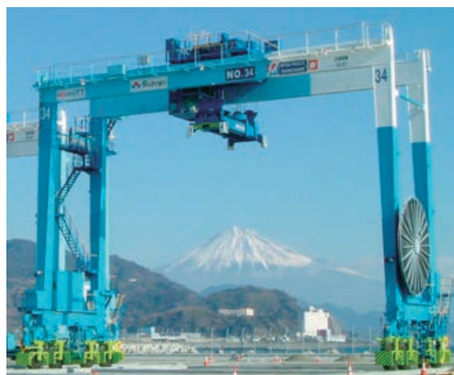
写真13 ケーブルリール給電式電動型トランスレーナ
