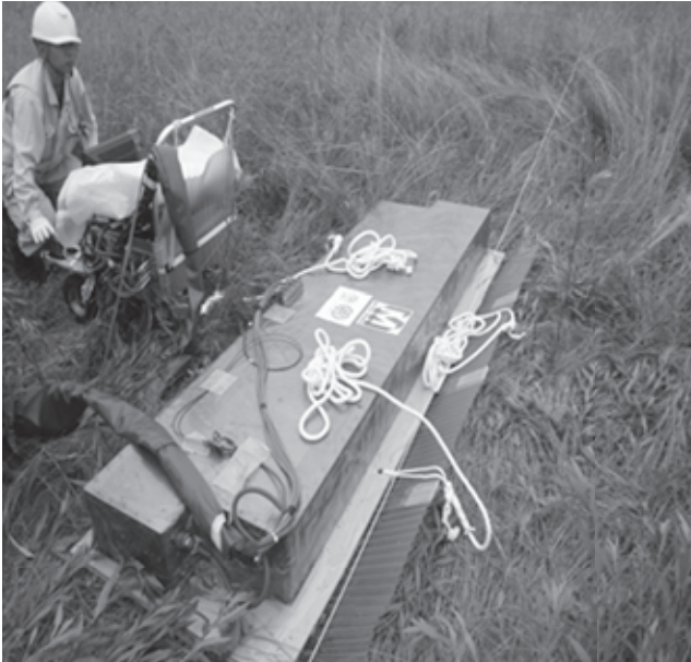
写真1 遺跡計測に使用したレーダと準備状況
