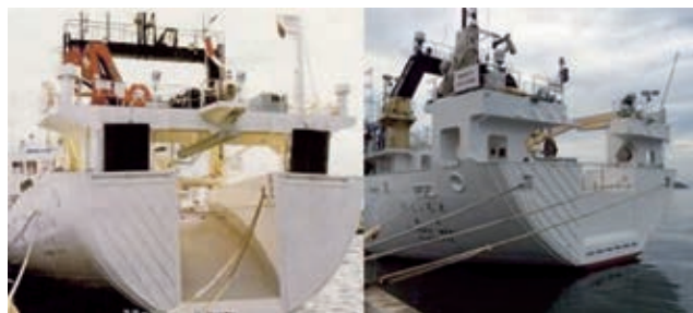
写真7 おしよる丸の船尾スリップウェイ (左は旧船 2) , 右が本船 3) でスリップウェイを起こした状態)
