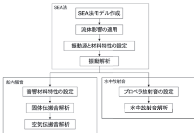
図3 騒音予測システムの解析手順 Schematic Diagram of Noise Prediction System
