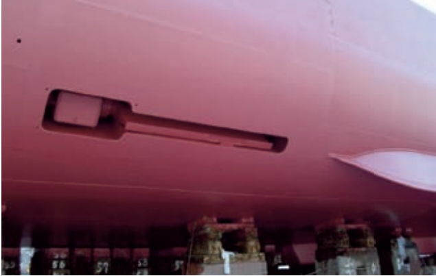
写真6 おしよる丸の格納式フィンスタビライザとビルジキール 3)
