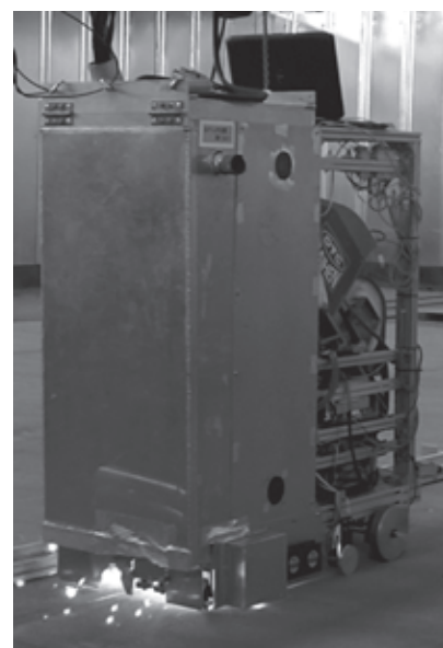
写真7 開先做い制御装置を搭載した溶接台車 Welding Carriage Equipped with Welding Line Profile Control Device
