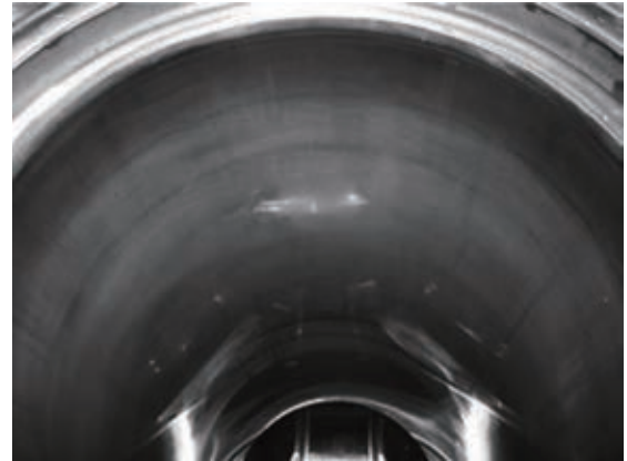
写真3 シリンダーライナー内面 Inside of Cylinder Liner
