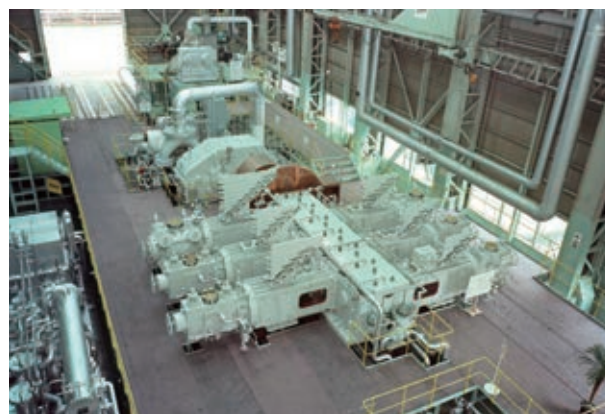
写真 2 高圧水素ガス圧縮機 (動力: 6 725 kW) High Pressure Hydrogen Gas Compressor (Power: 6 725 kW)
