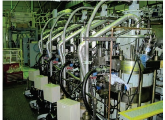
写真2 三井造船テストエンジン4S50ME-Tでのメタノール運転の状況
