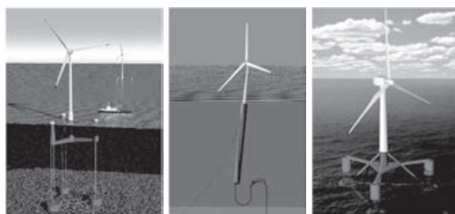
(a) TLP (b) SPAR (c) セミサブ
